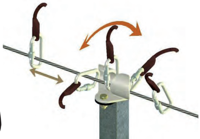
Exemples d'ancres structurelles intermédiaires.
