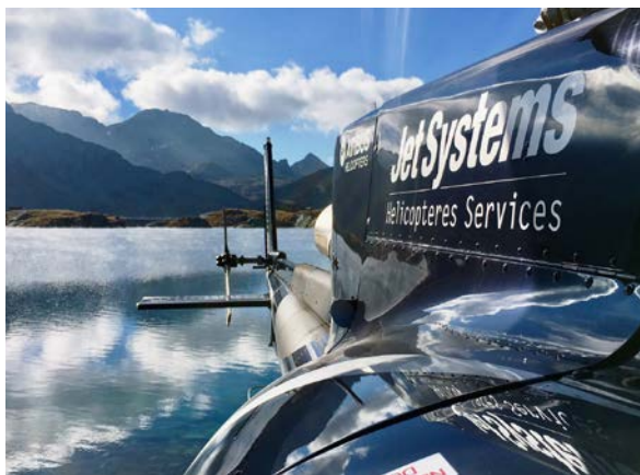
RAC Rotor anti-couple en queue d'hélicoptère.
