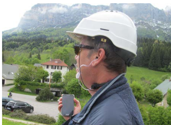
L'utilisation d'un laryngophone permet de parler sans être gêné par le bruit extérieur du souffle des pales puisque le son est transmis par contact au niveau du cou.
